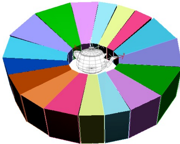
figura 4.3 – Cada cor representa uma região onde uma mesma textura com relevo pode ser utilizada. Através da ilustração, pode-se notar que o tempo de vida de cada textura deste tipo é muito maior que o tempo de vida de um sprite .
