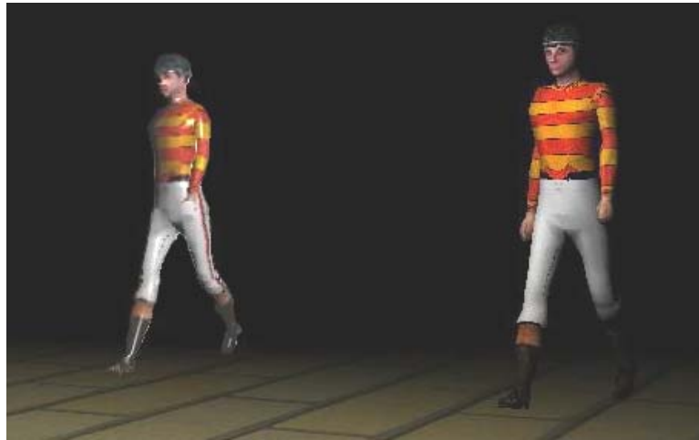
figura 8.13 – O personagem da esquerda foi renderizado pelo software shader de Ray-tracing e o personagem da direita foi renderizado diretamente pela GPU.
