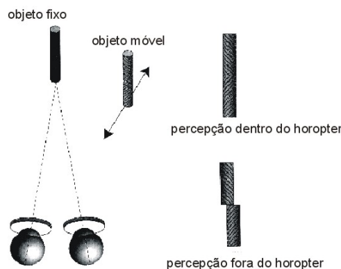
Figura 5.16: Método para medir o horoptero Nonius (10)
