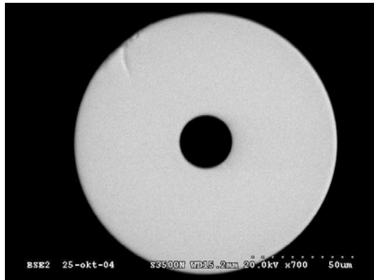
Figura 61 - Fibra capilar (ACREO/Suécia) F020607-1. O diâmetro externo da fibra é de 125 \mu\text{m} e do buraco é de 25 \mu\text{m} .
