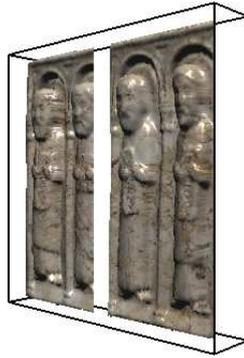
Figura 4.7: Visão incompleta da superfície representada. Devido ao *warping*, os *texels* deslocaram-se para a direita. Na metade esquerda, a imagem foi cortada devido ao suporte da mesma estender-se somente até a metade da textura original. Na metade direita, um espaço em branco surge uma vez que as amostras que preencheriam tal espaço foram perdidas devido à restrição de tamanho do suporte da metade esquerda.
