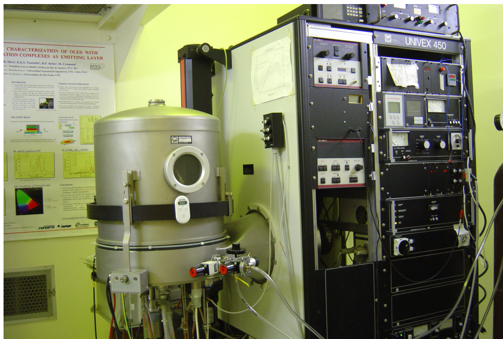
Figura 3.5 – Foto do equipamento de deposição por feixe de elétrons utilizado.
