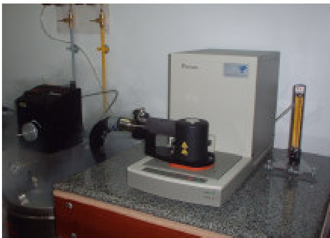
Figura 3.8 – Prensa utilizada no fechamento da panela contendo as amostras para as medidas de DSC.
