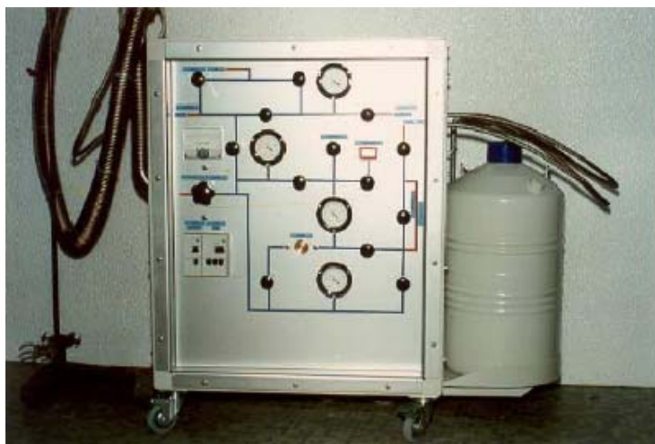
Figura 4.11. Painel de controle do sistema de bombeamento.
