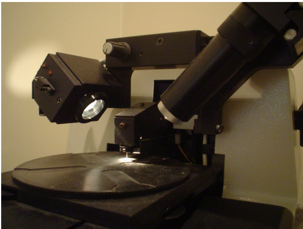
Figura 3.9 Imagem do perfilômetro DEKTAk 3 do Laboratório Van de Graaff.
