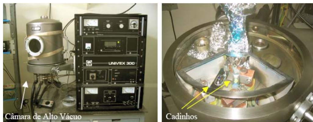
Fig. 4.2 – Fotos mostrando o equipamento de deposição utilizado (UNIVEX 300) (esquerda) e parte interior da câmara de alto vácuo, onde são colocados os cadinhos com os materiais a serem depositados.
