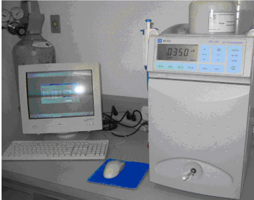
Figura 8: Cromatógrafo de Íons modelo DX-120 da Dionex utilizado na PUC-Rio.
