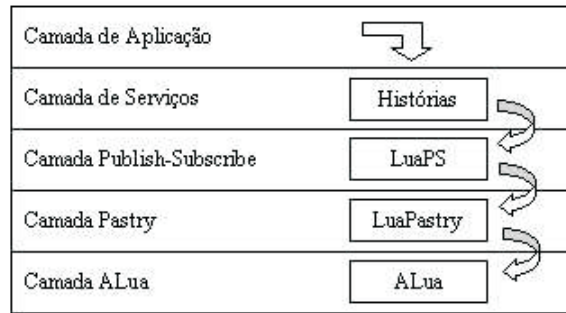
Figura 5.9: Aplicação com um Módulo de Serviço
