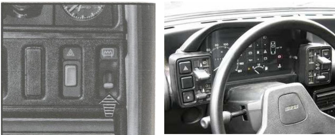
Figura 6 – Exemplo de comando do tipo alavanca, à esquerda no painel do Monza (MANUAL DO PROPRIETÁRIO DO MONZA, 1984) e à direita, do Uno.
