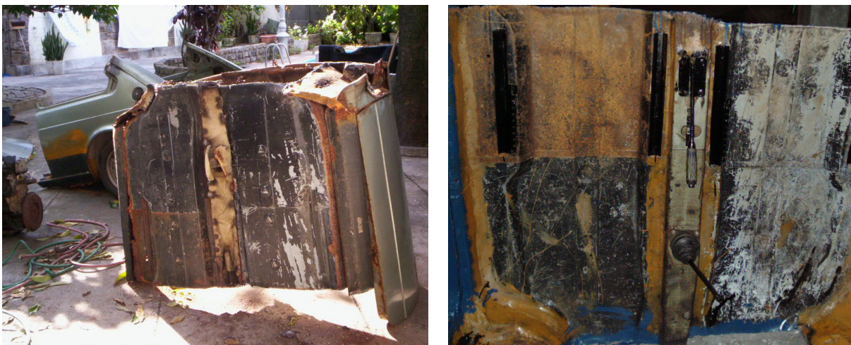
Figura 83 – Retirada de parte do chassi.
