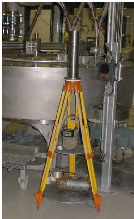
Figura 20 Fotografia do amostrador do tipo impactador em cascata no local de coleta.
