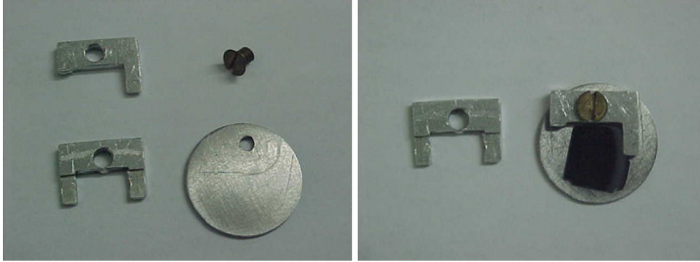
Figura 28 - Foto das peças do porta-amostra desmontado a esquerda, e montado com um substrato de InP a direita.
