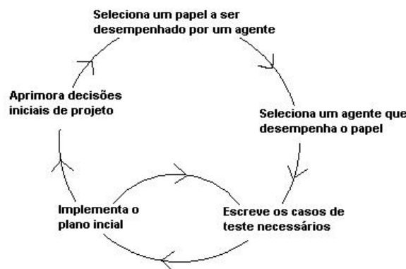
Figura 3.6: Processo para Desenvolvimento Orientado a Testes de Agentes
