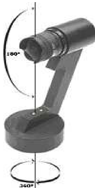
Figura 1.2: Câmera HDR de escaneamento panorâmico SpheroCamHDR (26 F-stops, resolução 10.600 pixels horizontal por 5.300 pixels vertical). Imagem e informações retiradas de www.spheron.com [2]
