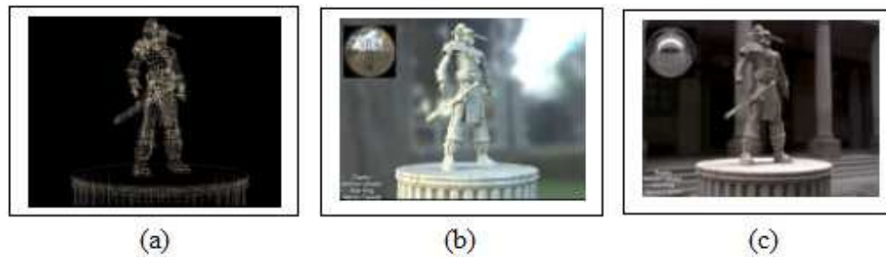
Figura 1.4: Composição de objetos sintéticos em fotografias usando sondas de luz HDR. (a) modelo geométrico do objeto sintético; (b) iluminação do objeto com fundo de floresta; (c) iluminação do objeto com fundo de museu . As sondas usadas estão indicadas no canto superior esquerdo. Material extraído de [3].
