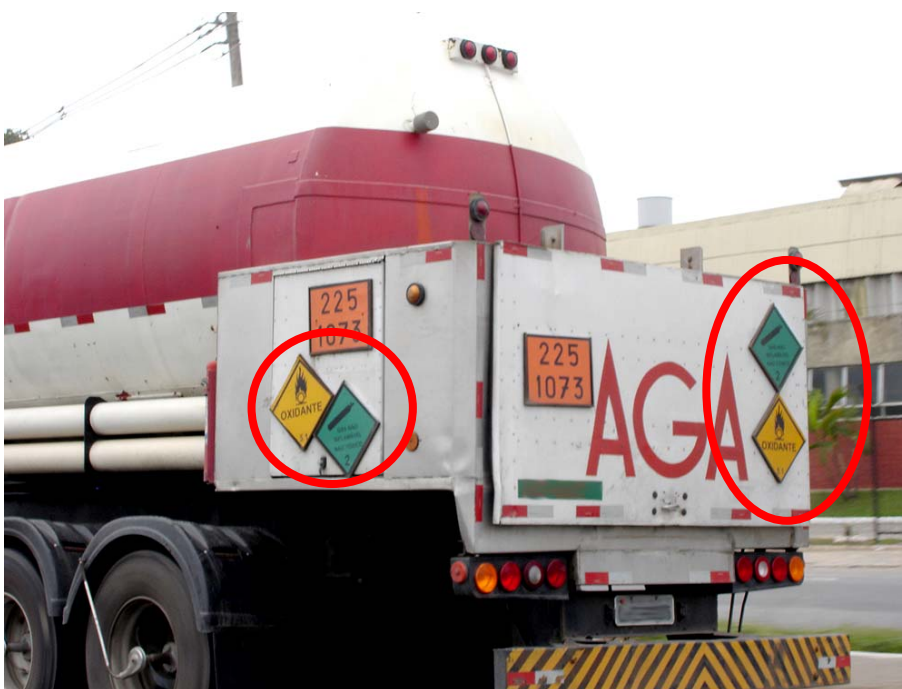
Figura 2-16 – Caminhão-tanque com o painel de segurança e destaque para os rótulos de risco (neste caso para Substância Oxidante e Gás não inflamável) (Fonte: a autora).
