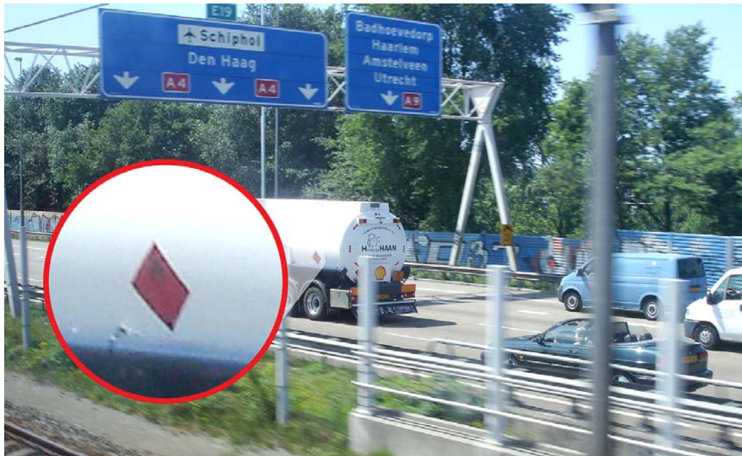
Figura 2-25 – Veículo transportando carga perigosa na Holanda. Os rótulos não apresentam as palavras (Fonte: a autora).
