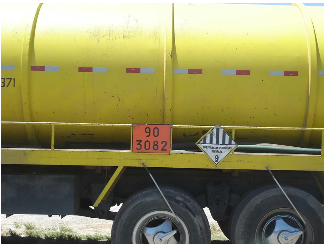
Figura 2-22 – Lateral de caminhão tanque com o painel de segurança e o rótulo de risco para substâncias perigosas diversas respectivamente (Fonte: a autora).
