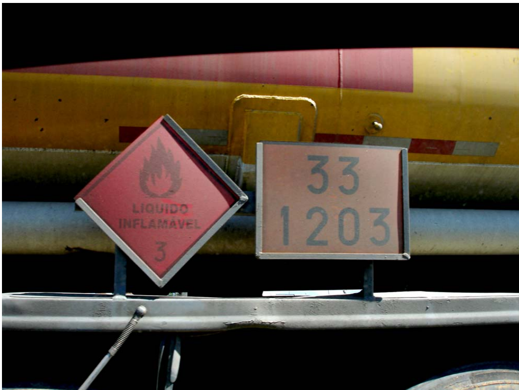
Figura 2-20 – Lateral de um caminhão tanque com o rótulo de risco para líquido inflamável e o painel de segurança (Fonte: a autora).
