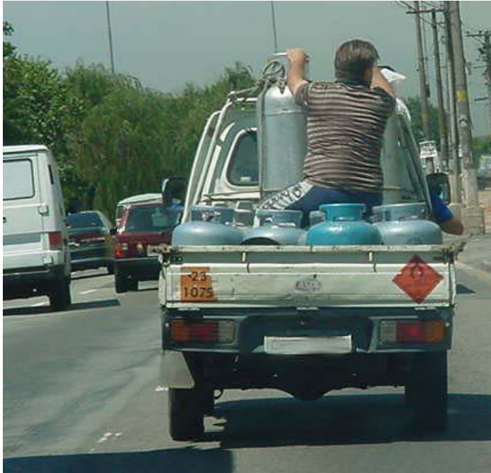
Figura 3-13 – Imagem do transporte de carga perigosa sendo feito de forma irregular (Fonte: www.produtosperigosos.com.br ).
