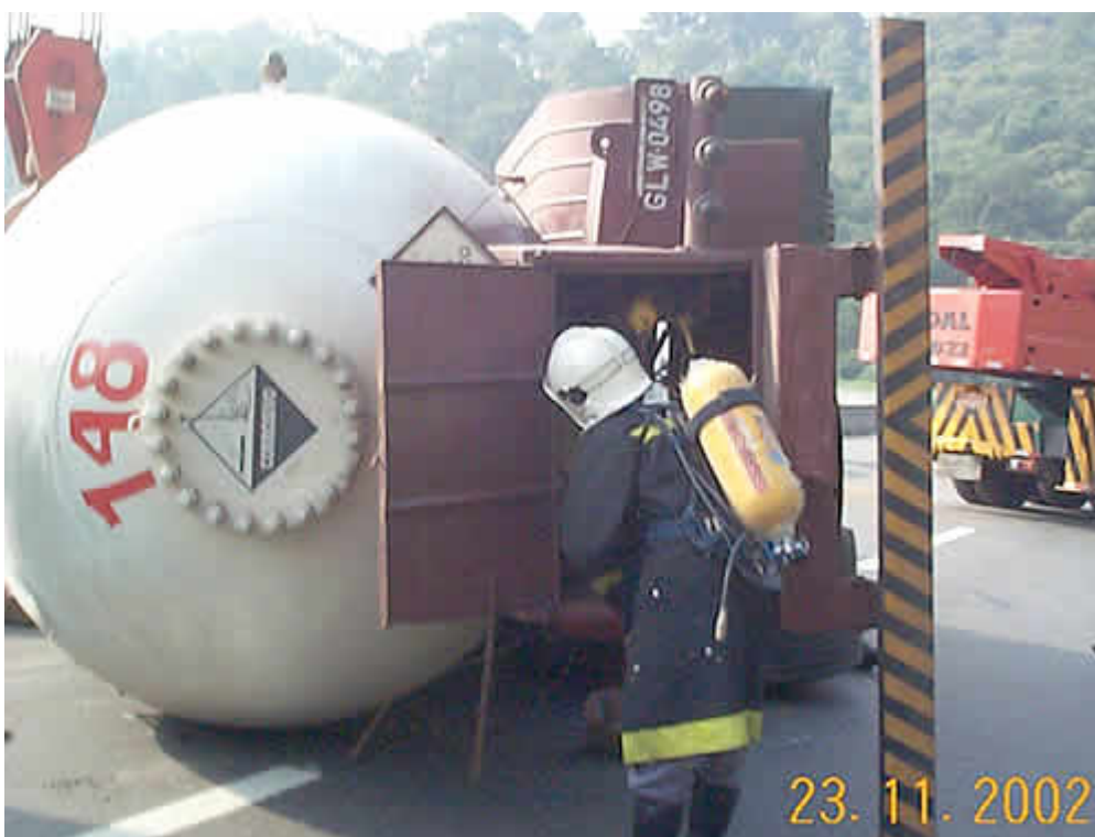
Figura 3-3 - Bombeiro examina caixa de válvulas de carreta acidentada (Fonte: CETESB – 2005)
