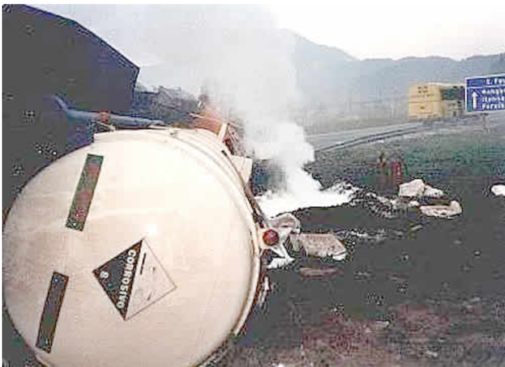
Figura 3-2 - Operação de neutralização - vazamento de produto corrosivo (Fonte: CETESB – 2005)
