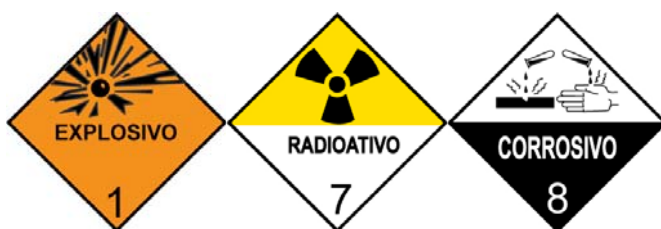
Figura 7-2 - Outros produtos também considerados muito perigosos: explosivo, radioativo e corrosivo.
