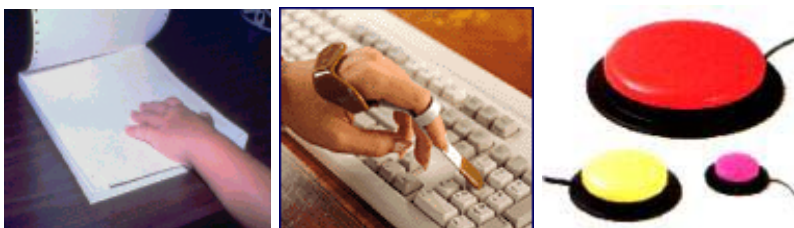
Figura 6: Impressão em braille, órtese para digitação, acionador de pressão – Categoria 3. Fonte: Bersch (2005).
