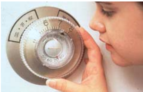
Figura 28: Uma pessoa com baixa visão opera na escala próxima um termostato redondo com números grandes, indicadores táteis, e sugestões audíveis. (Fonte: http://www.design.ncsu.edu/cud/newweb/about_ud/udprinciples.htm )
