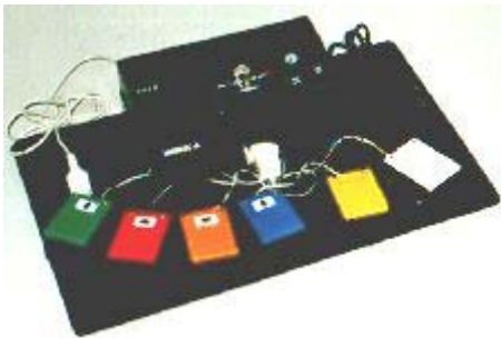
Figura 17: Switch Mouse que substitui a ação do mouse convencional por meio de 7 acionadores de toque simples, permitindo os movimentos direcionais do cursor, clique único, duplo-clique e acionamento da tecla direita do mouse. Também apresenta chave tipo liga/desliga para a função arrastar. (Fonte: http://www.clik.com.br/ )
