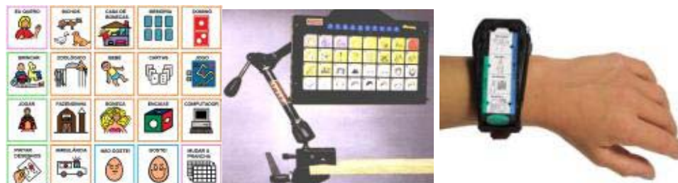
Figura 4: Prancha de comunicação, vocalizador com varredura e vocalizador portátil – Categoria 2. Fonte: Bersch (2005).
