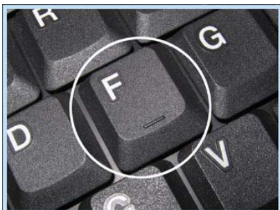
Ilustração 4 – Tecla de computador com a letra F e seu relevo. Fonte: http://www.bengalalegal.com/capitulomaq.php .
