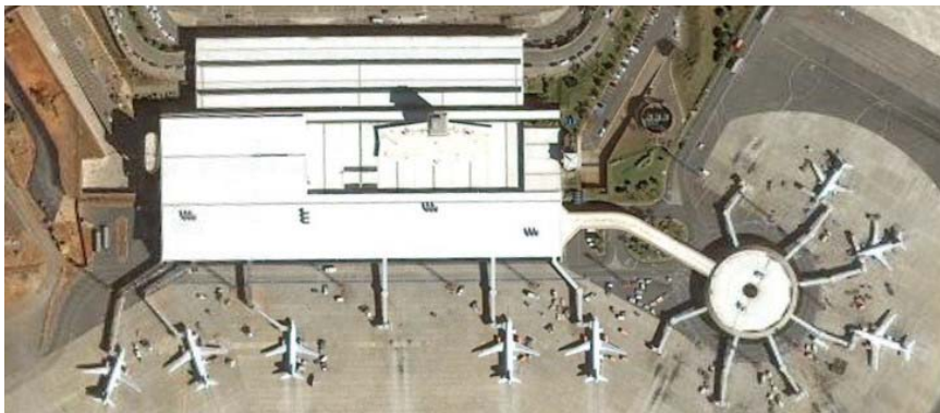
Figura 16: Aeroporto de Brasília – centralizado em dois níveis com satélite (Fonte: Google Maps)
