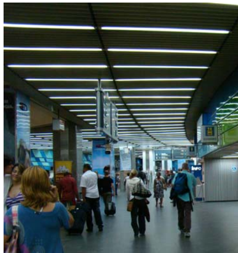
Figura 63: Luminárias criam caminho de luz que camuflam as placas de sinalização.
