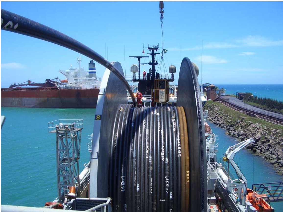
Figura 24 - Foto do carretel em um enrolamento típico na embarcação Skandi Navica pertencente à Subsea 7
