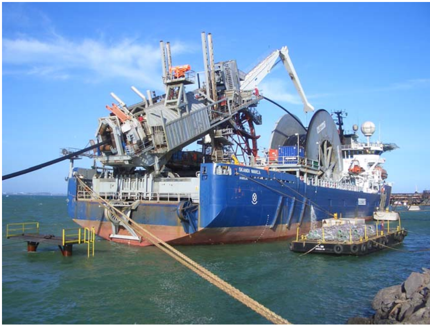
Figura 23 - Foto de um enrolamento típico na embarcação Skandi Navica pertencente à Subsea 7
