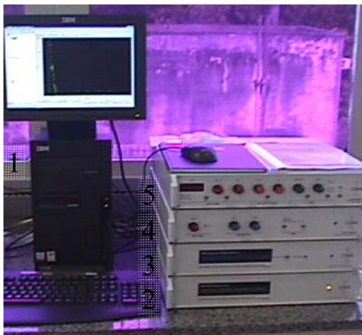
Figura 5.1 – 1: Computador, 2: DataStation Hub (Controlador de NanoLEDs, monocromadores, polarizadores, lentes e detector de fótons TBX), 3: Fonte e controle para o detector MCP, 4: Fonte e controle para lâmpada de Xenônio, 5: Fonte e controle para lâmpada NanoFlash.
