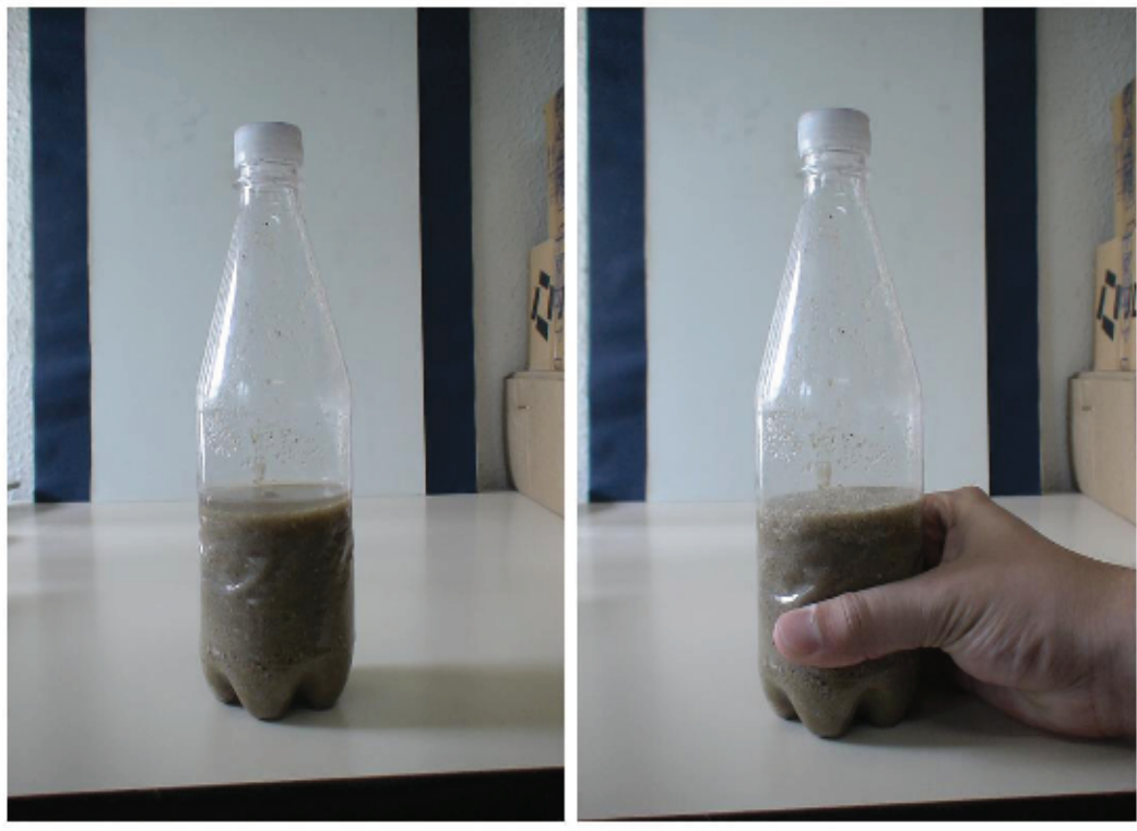
Figura 1.2: Reprodução da experiência proposta por Reynolds: uma garrafa plástica, cheia de areia e água, é deformada, fazendo o nível da água baixar. Quando a garrafa volta ao normal, o nível da água sobe novamente.
