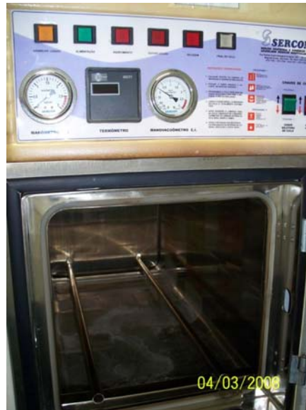
Figura 33: Autoclave SERCON, Modelo HEA15
