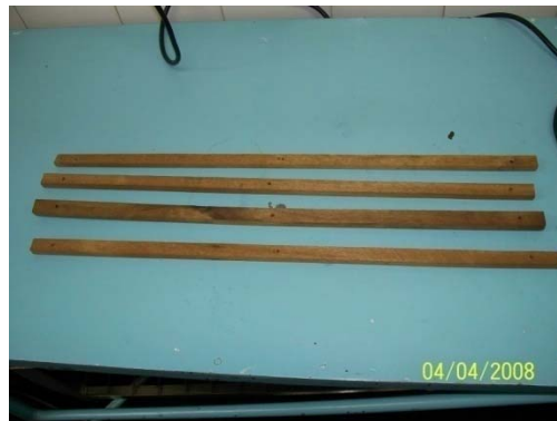
Figura 35: Régua em madeira, contendo orifícios para o posicionamento dos sensores no interior da câmara de esterilização.
