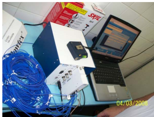
Figura 34: Montagem do sistema composto pelo Hardware (Termopares, SCXI-1000, SCXI-1303, SCXI-1202 e SCXI-1600), computador portátil e software.
