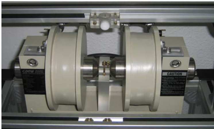
Figura 0-1: Eletroímã com o qual foi feita a caracterização magnética.
