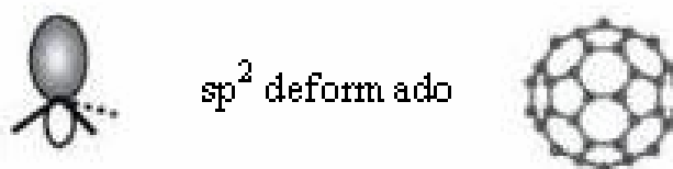
Figura 3_Estrutura da molécula de fulereno, mostrando hibridização sp^2 ligeiramente deformada.
