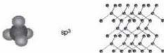
Figura 1_ Estrutura do diamante, mostrando hibridização sp^3 .
