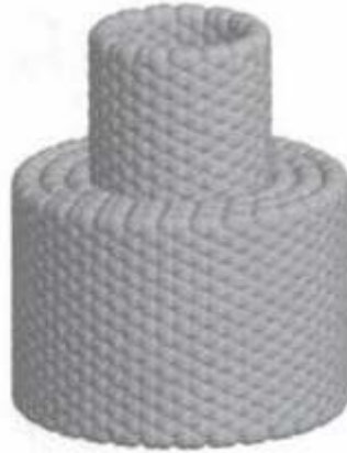
Figura 11_ Representação esquemática de um nanotubo de carbono de paredes múltipla [27].
