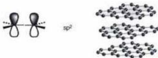
Figura 2_ Estrutura do grafite, mostrando hibridização sp^2 .
