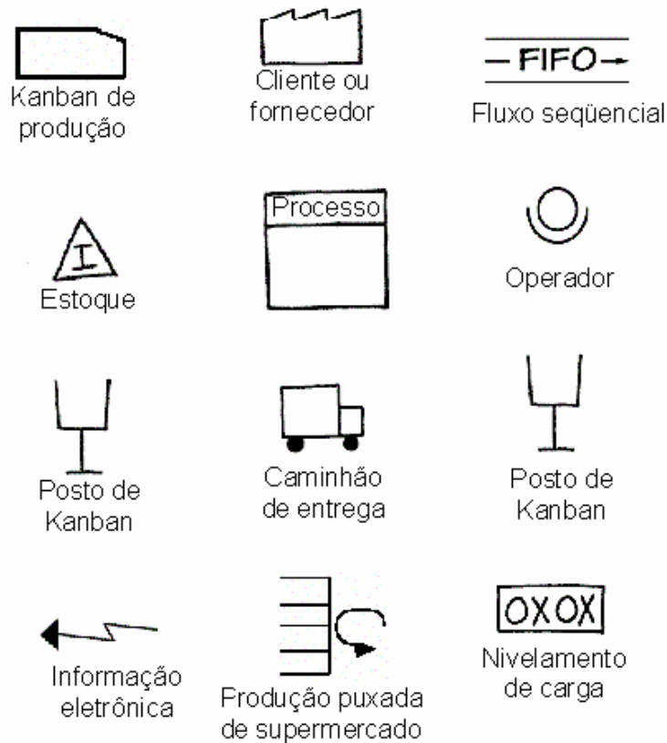
Figura 4 - Exemplo de ícones utilizando na técnica de Mapeamento do Fluxo de Valor
