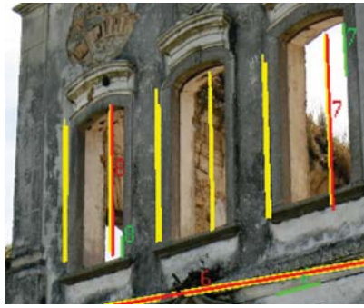
4.3(a): Correlações calculadas automaticamente entre modelo e imagem. As arestas em amarelo são as arestas do modelo, que está atrás da imagem. Os segmentos vermelhos são os segmentos do modelo que foram associados com a imagem e os verdes são suas respectivas associações com a imagem.
