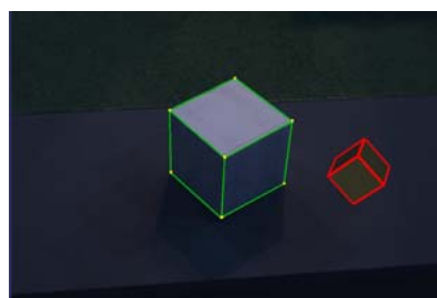
5.3(b): Posição e orientação iniciais de câmera fornecidos como entrada para o método proposto. As marcações em verde foram feitas para mapear o cubo real na imagem. As arestas em vermelho são as arestas do cubo virtual na posição inicial (R_0, T_0) .
