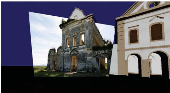
Figura 5.4: Imagem real da aplicação 3D-Pose. Casamento entre imagem e modelo de uma edificação.
