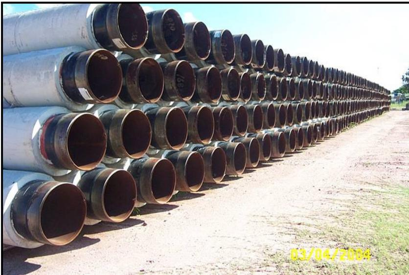
**Ilustração 2 – Tubos revestidos em concreto**
