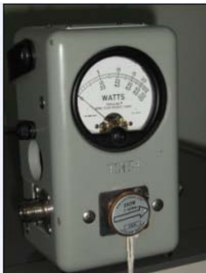
Figura 7 – Wattímetro, podendo-se notar ainda o elemento sensor.
