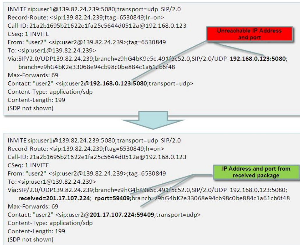
Figura 7 – Exemplo de mensagem SIP enviada a partir de um User Agent executando em um dispositivo anexado a uma sub-rede com NAT.
