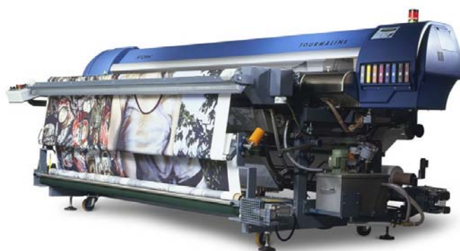
Figura 126.: Máquina de estampar digital marca Stork, modelo Tourmaline
