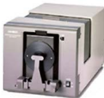
Figura 121.: Espectrofotômetro de bancada Minolta modelo CM-3720d
