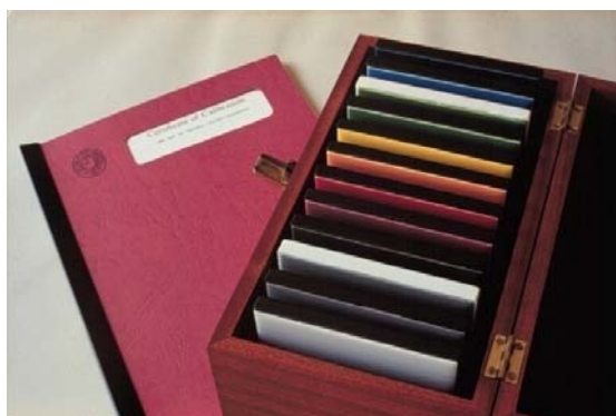
Figura 122.: Certificado de calibração e caixa de 12 azulejos calibrados pelo NPL
