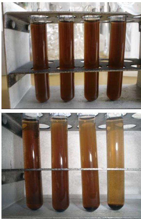
Figura 51: Fotos dos tubos com solução tampão em diferentes valores de pH. Acima, logo após o preparo e abaixo, uma semana depois do preparo. Da esquerda para a direita, pH 4, 6, 7 e 8.
