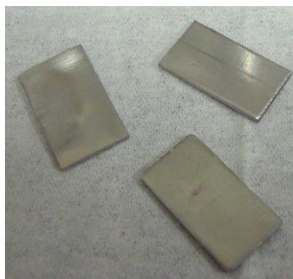
Figura 5.3. Fotografia dos substratos utilizados: peças de aço inoxidável 316L.
