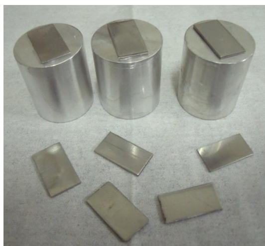
Figura 5.4. Fotografia que mostra os substratos de aços colados em pequenos cilindros de alumínio para seu posterior polimento.
