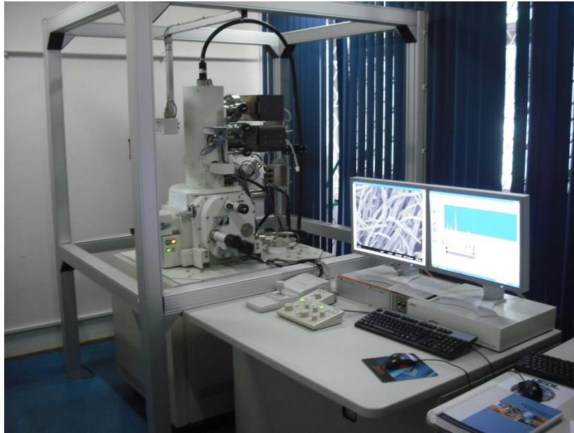
Figura 4.4. Fotografia do microscópio eletrônico de varredura com canhão de elétrons com emissão por efeito de campo, modelo JSM-6701F da JEOL, com detector anular de campo escuro (ADF) para fazer imagens por STEM e detectores para EDS, utilizado para caracterizar as amostras.
