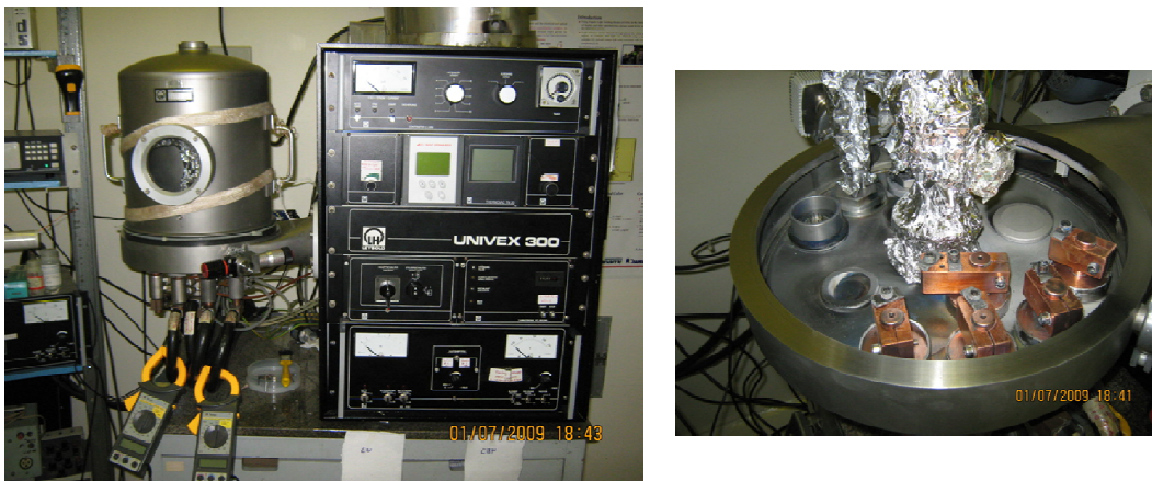
Figura 2-4 – Sistema de deposição de filmes finos no LOEM – PUC-Rio.
