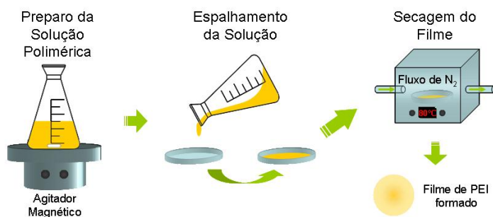
Figura 3.6: Esquema do processo de fabricação dos filmes de PEI.
