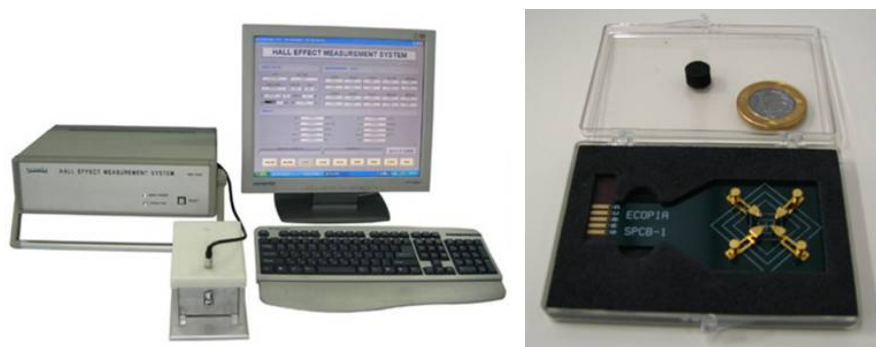
Figura 3.11: Equipamento de medida e porta amostra para medidas de efeito Hall da ECOPIA Hall Effect Measurement System HS 3000.
