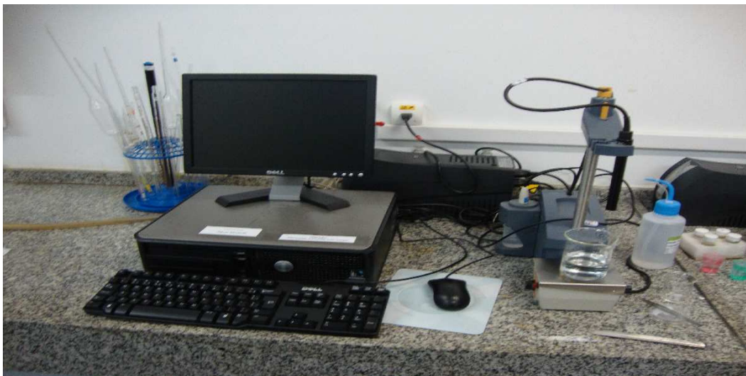
Figura 11: Foto do equipamento utilizado para a realização do ensaio de determinação de pH seguido pelo LABAGUAS.
