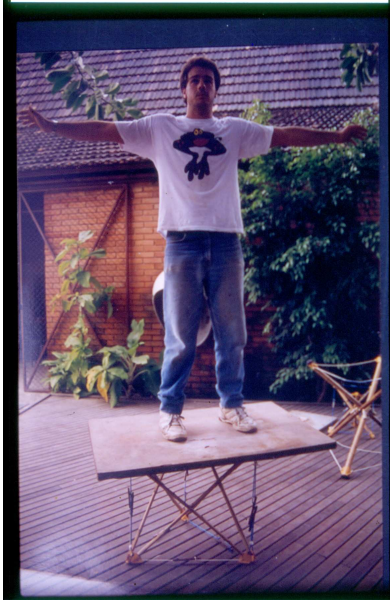
Fig. 20 – Prisma Autotencionado com bambus e cabos.
