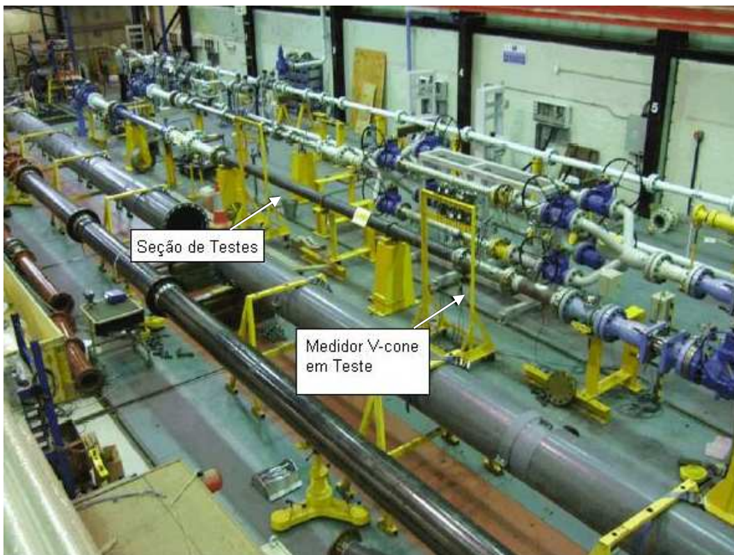
Figura 13 – Circuito de testes do laboratório NEL
