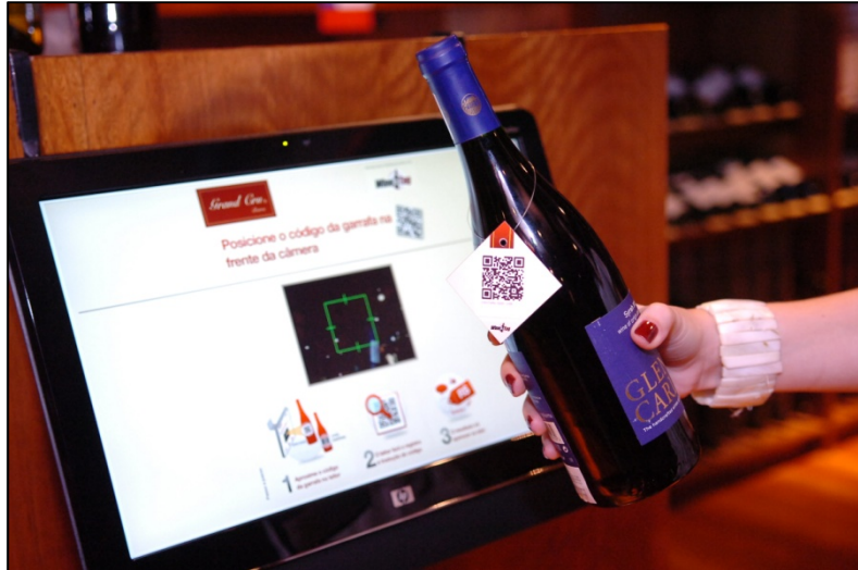
Figura 36 – Tela Tag Screen: Computador all-in-one que decodifica dados do vinho contido no QR Code das etiquetas para indicar produtos relacionados através de uma web cam embutida
