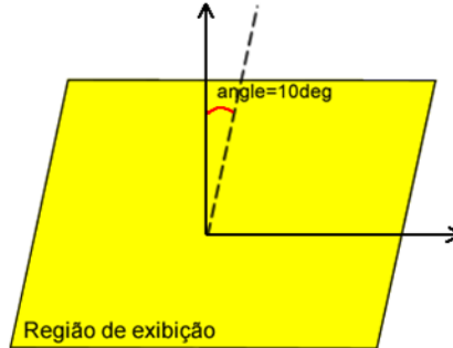
Figura 48 Exemplo de definição de transformação de cisalhamento em NCL, por meio de parâmetros nos descritores, segundo as notações (i) e (ii).
