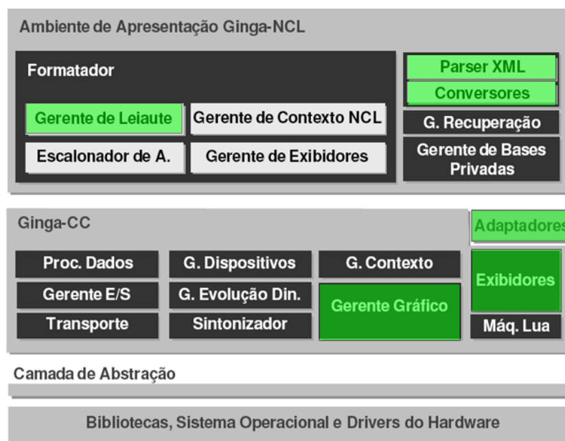
Figura 57 Arquitetura da Implementação de Referência do Ginga-NCL evidenciando os pontos que foram modificados por esta dissertação. Adaptado de (MORENO, 2010).
