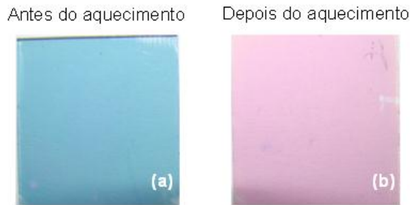
Figura 18: Filme fino de ouro de 6 nm de espessura antes do aquecimento (a) e depois do aquecimento (b).
